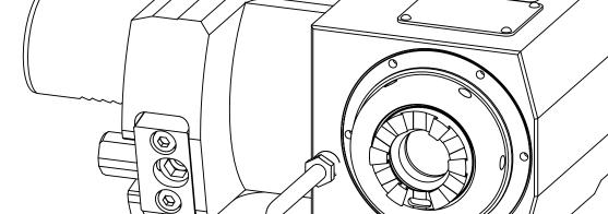
Kühlmittelzufuhr i.K. durch die Spindel und e.K. über Spritzrohr internal coolant supply through the spindle and external coolant supply through pipes
